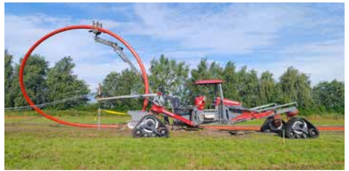
Die Frank Föckersperger GmbH hat den ersten Kabelpflug-Spider weltweit mit Delta-Laufwerken entwickelt.
