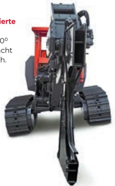
V225 mit Kettenpolstern zur Schonung befestigter Oberflächen
