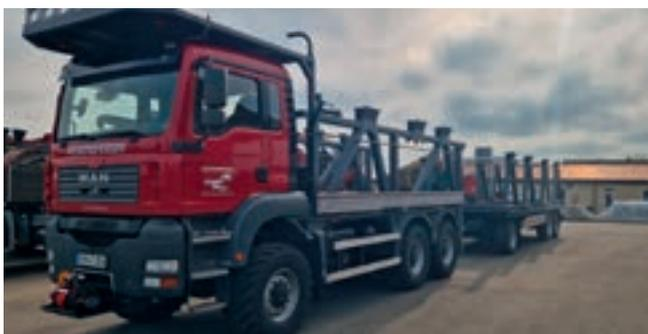
Option: Schienenaufbau zum Verschieben der Kabeltrommelgestelle auf dem Anhänger.
