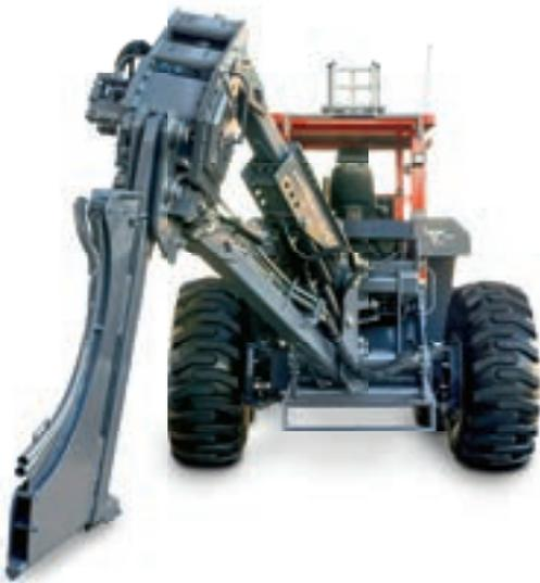
Die Vibrationspflugeinheit ist **hydraulisch schwenkbar** und erlaubt somit seitenversetztes Pflügen entlang von Straßen oder Gräben.
