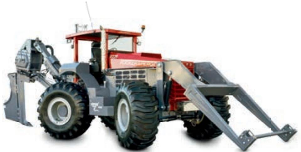
Ein besonderes Merkmal ist die **integrierte Neigungsfunktion**. Dadurch kann der komplette Rahmen seitlich bis 10° hydraulisch gekippt werden, dies macht das Pflügen im Hangbereich möglich.
