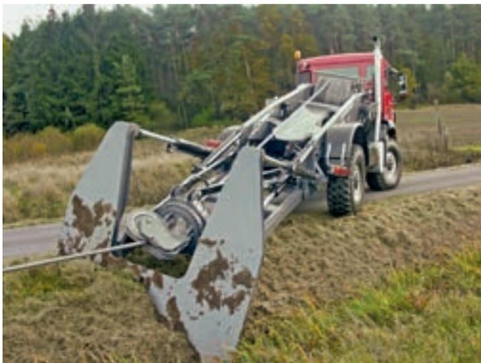
Das Schwenken des Rahmens, das Neigen des Abstützschildes und die DREHMATIK-Spülung gewährleisten in jeder Position maximale Zugleistung. Der F890 ist wie verankert und „hebt“ nie ab!
