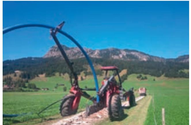
Mit dem Rohr- und Kabelpflug Spider lassen sich flexible Kabel und Rohre bis 500 mm Außendurchmesser einfach und effizient einpflügen. Auch mehrere Kabel und Druckleitungen können gleichzeitig verlegt werden – inklusive Trassenwarnband.
