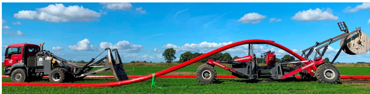
Seitenansicht Rohr- und Kabelpflugsystem mit 280 mm Kabelschutzrohr
